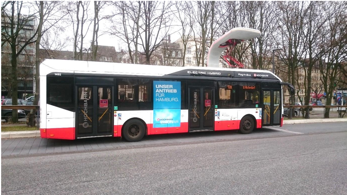
Kuva 11. Ladattava hybridibussi pikalatauksessa Saksan Hampurissa
