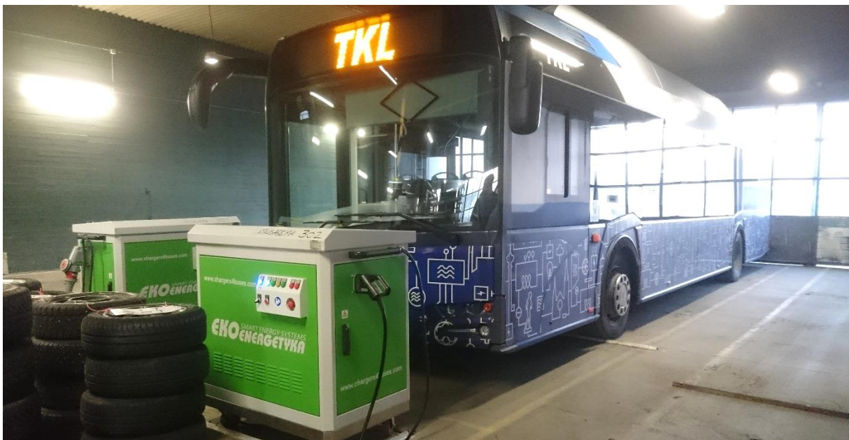
Kuva 7. Täyssähköbussi hidaslatauksessa Tampereella
