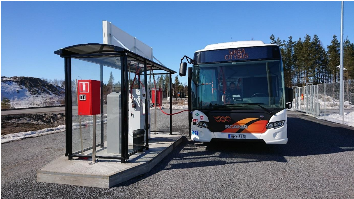
Kuva 3. Kaasubussi pikatankkauksessa kaasubussivarikolla
