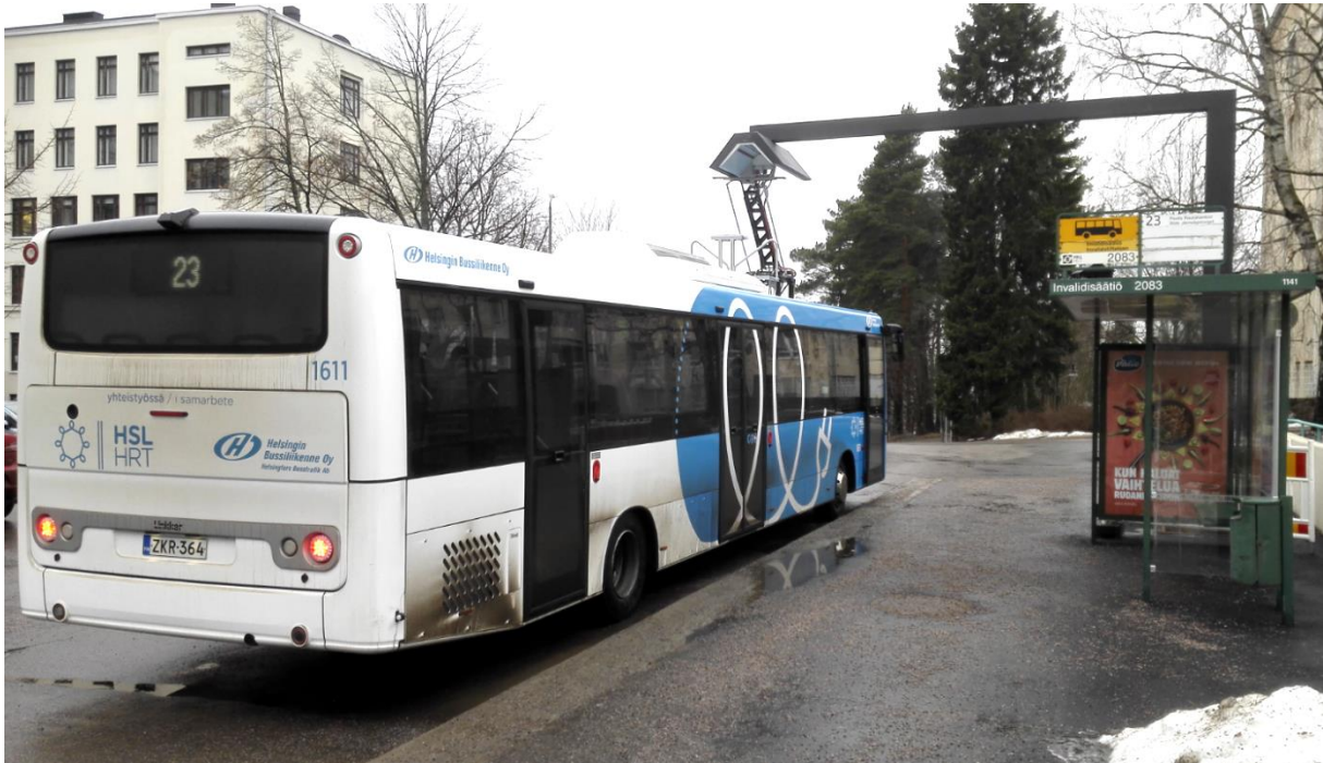
Kuva 6. Täyssähköbussi pikalatauksessa Helsingin Ruskeasuon pääte pysäkillä.
